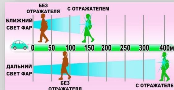
При движении с дальним светом фар он заметит пешехода на расстоянии до **400 метров**.
